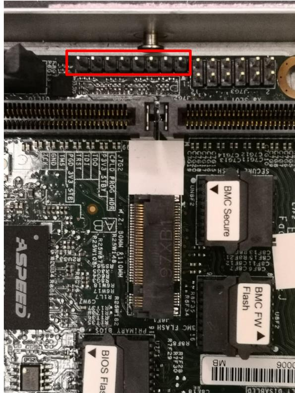
*Рисунок 2. Разъём платы для подключения программатора*
