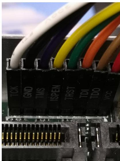
*Рисунок 3. Подключение кабеля JTAG в разъём платы.*
