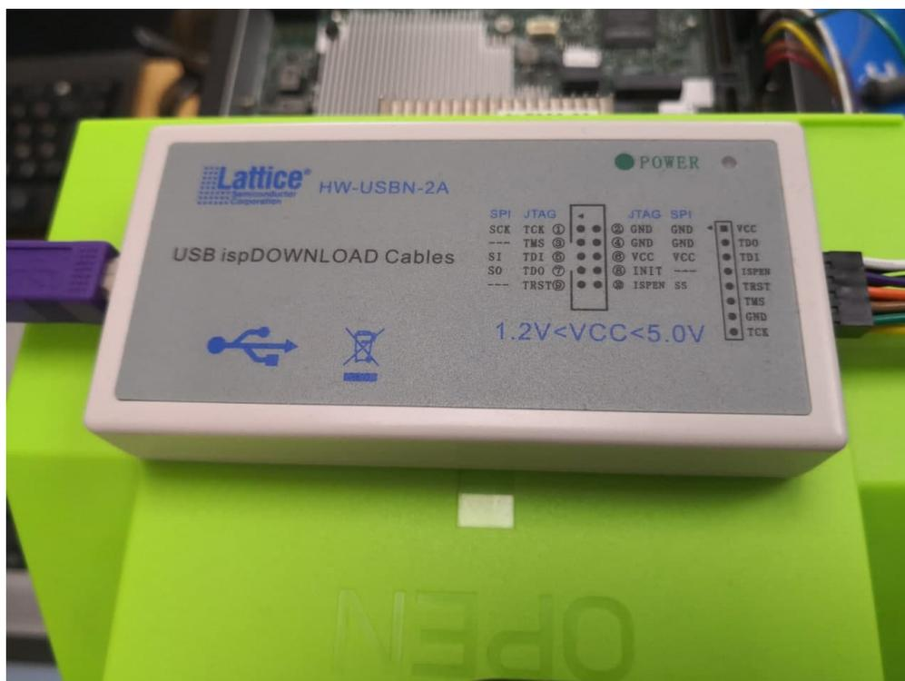
Рисунок 1. Программатор Lattice Semiconductor Corporation
