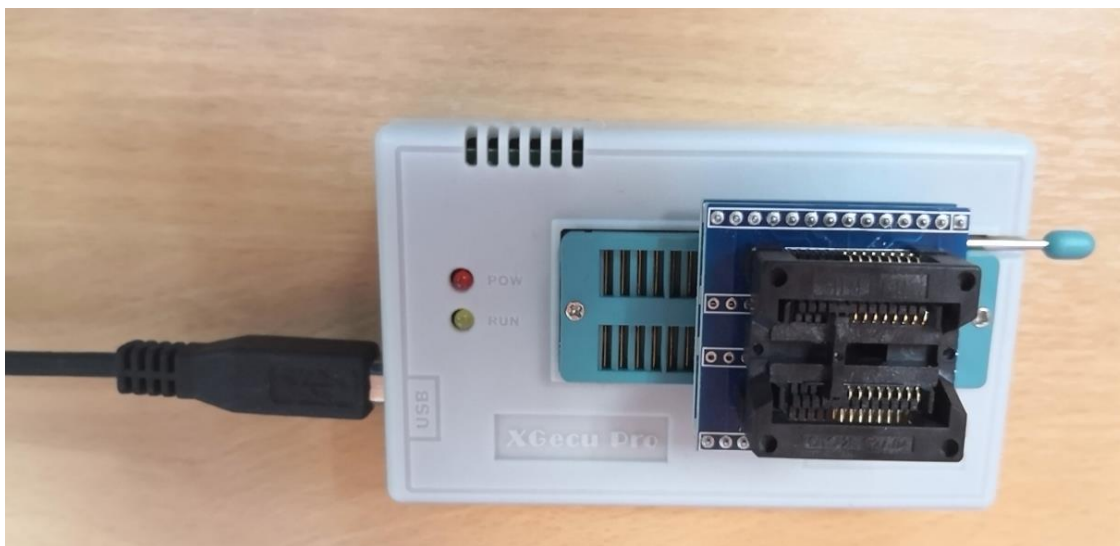
Рисунок 1. Программатор для микросхемы BIOS
